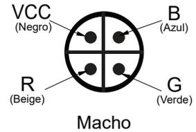
Diagrama de conexión 1. Este producto puede utilizarse por sí solo o puede conectarlo a más de un reflector (Máx 50pzas).
